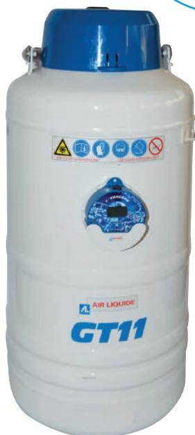
T° TRACKER - это портативное устройство на батарейках, обеспечивающее протоколирование температуры во время транспортировки образцов. Оно снабжено дисплеем и производит измерение значений температуры внутри контейнера посредством датчика PT100 и запись с заданным интервалом во встроенную память. Экспорт данных производится путем подключения к компьютеру через порт USB. Подходит для контейнеров серий GT, ARPEGE, ESPACE, RCB и VOYAGEUR.
