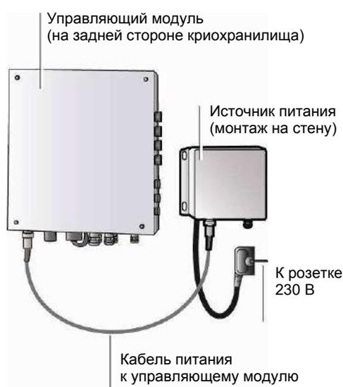
Рис. 5-3: Подключение управляющего модуля к электропитанию
