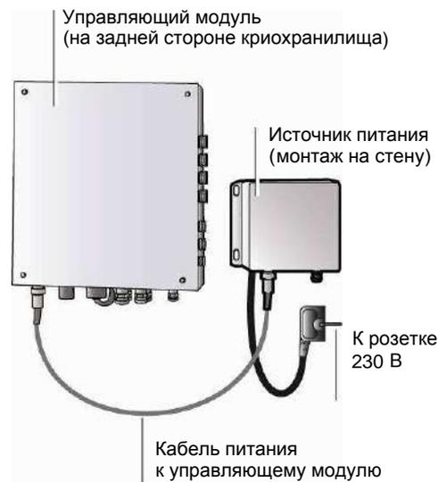
Рис. 5-3: Подключение управляющего модуля к электропитанию
