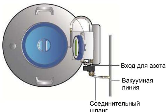
Рис. 5-2: Схема подключения к жидкостной линии
