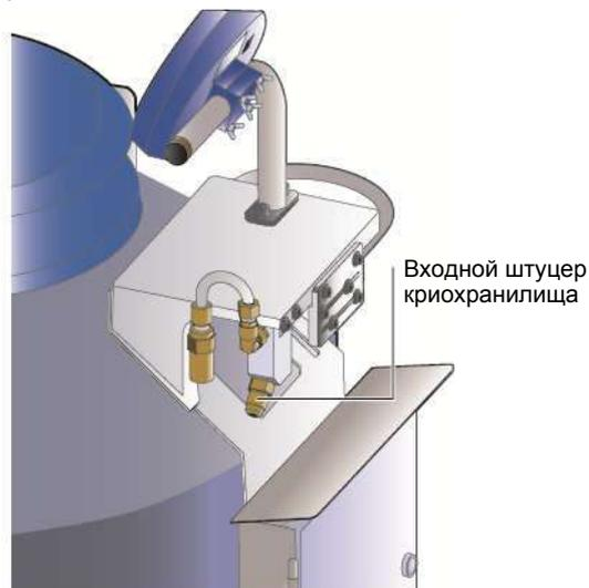
Рис. 7-1 : Подключение криохранилища к питающей линии
