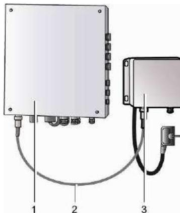
Рис. 9-1 : Соединительный кабель между источником питания и управляющим модулем
