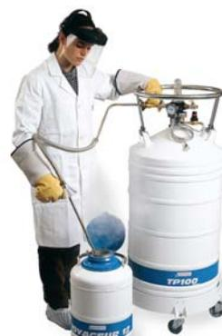
4. Удерживая шланг, **постепенно** открывайте клапан (1), чтобы начать раздачу азота, контролируя его поток.
