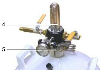
3. Поднимите систему управления (4) из резервуара и положите ее на соответствующее место.
