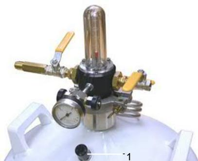
8. Закройте клапан заполнения/раздачи (1). Отсоедините гибкий шланг от сосуда TP и от питающей линии (резервуара) (4). Закройте клапан сброса (2), как только газ перестанет выходить из него.
