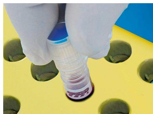
*Криопробирки TPP в обновлённом криоштативе находятся в такой позиции, что позволяет исследователю увидеть мельчайший объём образца в пробирке. Система углублений, совпадающих по форме с основанием пробирки, фиксирует пробирку в штативе и не допускает поворотов, что делает возможным работу одной рукой.*
