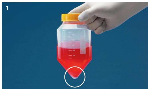
1 Благодаря подходящей форме сосуда, не требуется проводить сбор клеток. Осаждение клеток можно производить прямо в TubeSpin®.
