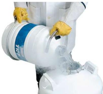
Рисунок 8-1: наполнение азотом сосуда TR; шаг 1.
