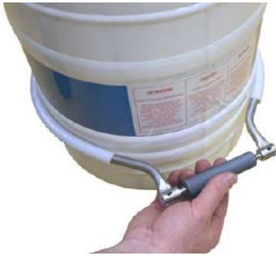
Рисунок 7-8: снятие ручки для опрокидывания.
