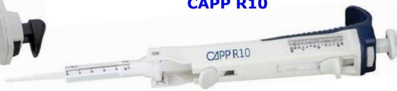
Степпер – это удобный инструмент для серийного шагового дозирования равных объемов жидкости.
